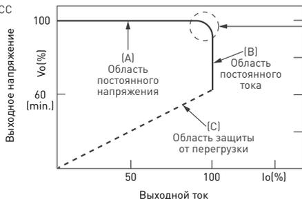
В области постоянного тока максимальное напряжение на выходе источника питания зависит от особенностей подключенной нагрузки
