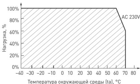
Рис. 3. Максимальная допустимая нагрузка, % от мощности источника
