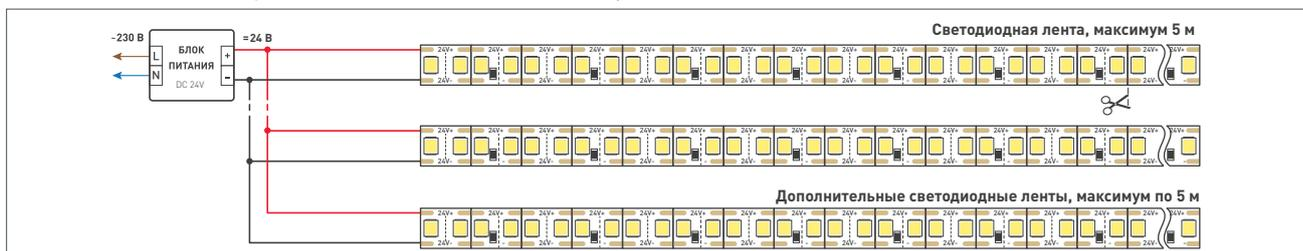
Подключение более двух светодиодных лент с двух сторон.
