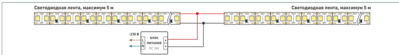
Подключение более двух светодиодных лент с одной стороны.
