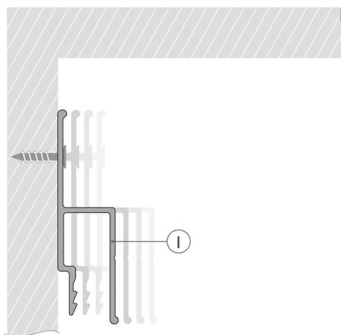
**2** / Вставьте гарпунное крепление **II** натяжного потолка в соответствующий паз профиля **I**. При необходимости закройте щель между профилем и стеной маскировочной лентой для натяжного потолка.
