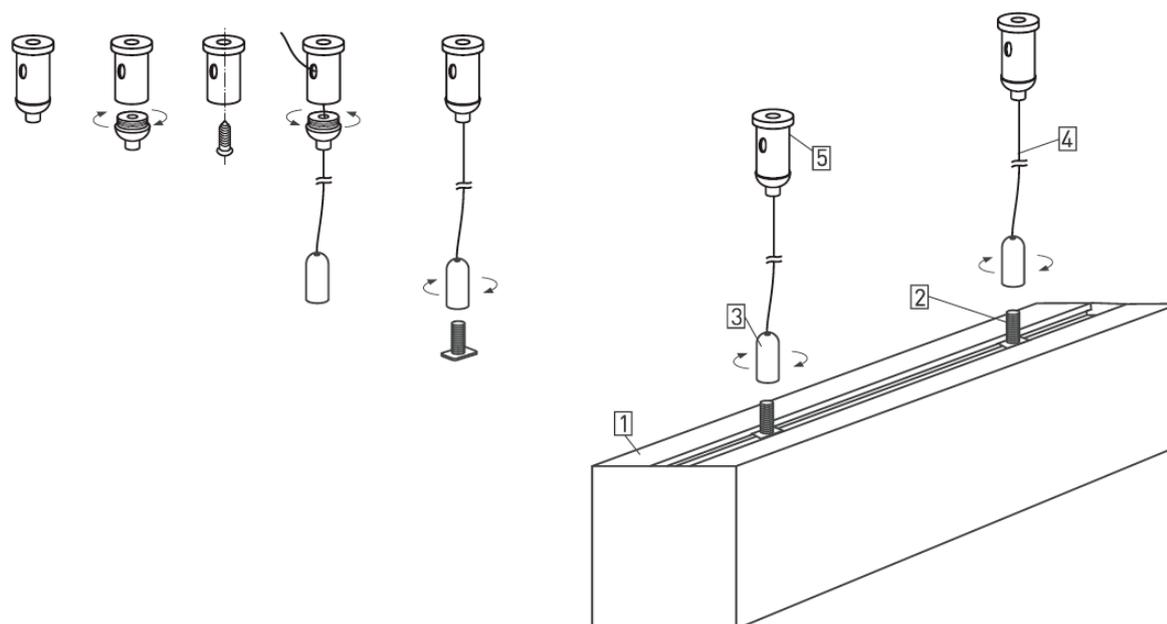
Рис. 1. Установка и подключение светильника
