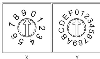
Рис. 2. Поворотные переключатели для установки адреса DALI
