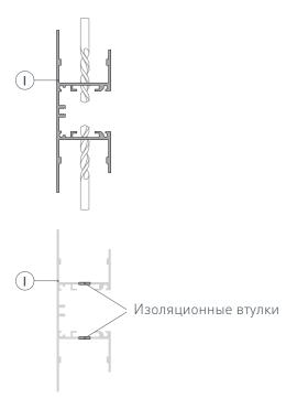
**2** / Закрепите держатели (V) на поверхности стены и выведите кабель от блока питания для светодиодных лент.
