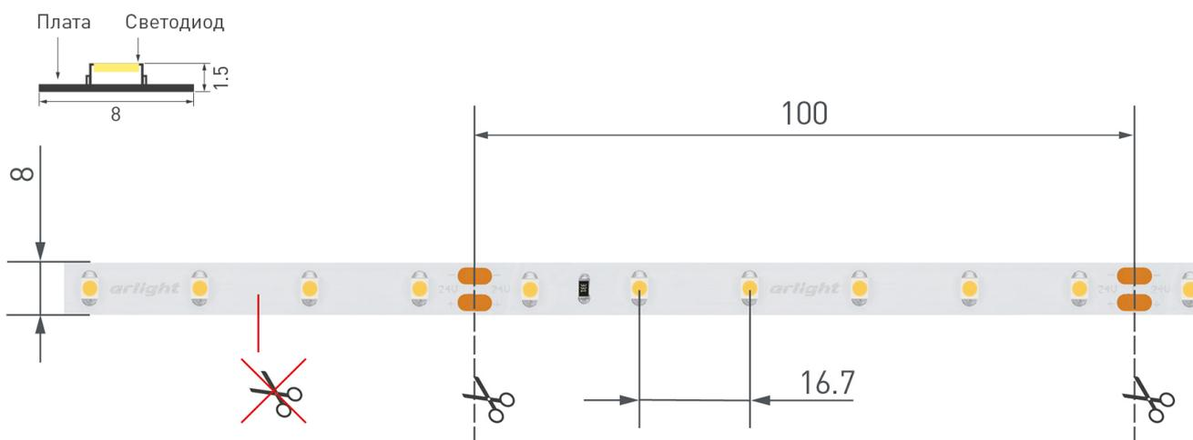
Не допускается разрезать ленту в необозначенном месте.
