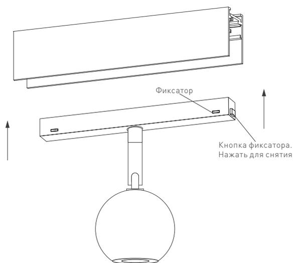
Рис. 2. Установка светильника
