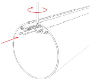
1. Просверлите отверстие и зафиксируйте соединитель на профиле.
