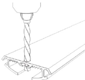
1. Просверлите отверстия для ввода кабеля питания.
