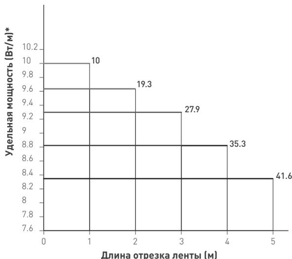
Удельная мощность ленты снижается при увеличении длины подключаемого отрезка из-за падения напряжения по длине ленты.
