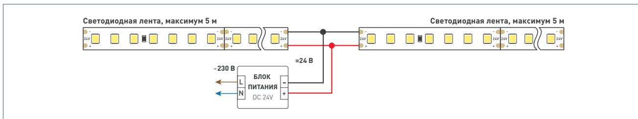
Подключение двух светодиодных лент с одной стороны.
