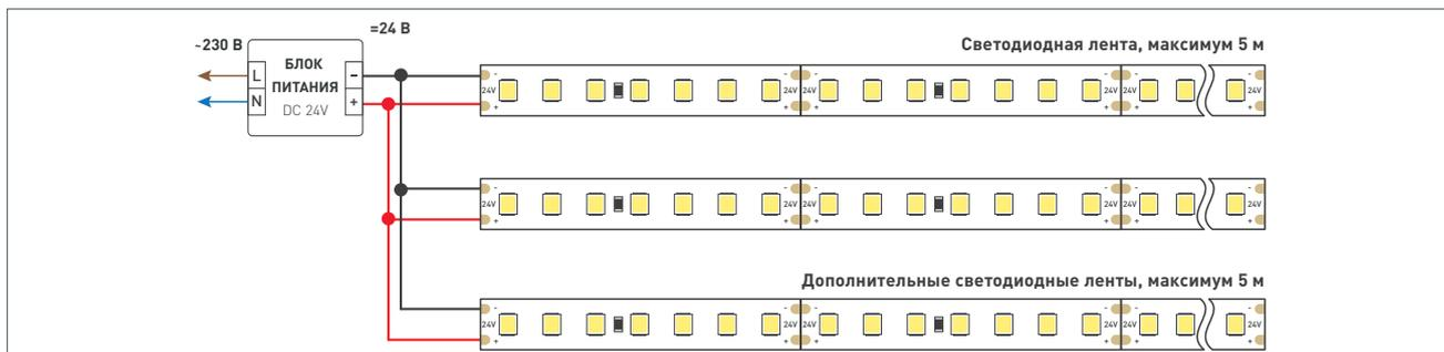
Подключение более двух светодиодных лент с одной стороны.
