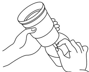
Подключите светодиодный модуль к разъему драйвера в корпусе светильника.
