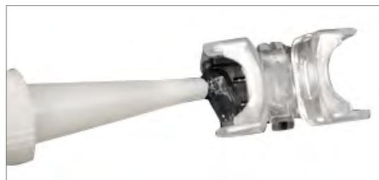
Нанесите герметик под крышки коннектора. Вставьте 2 отрезка светодиодной ленты в коннектор до упора согласно изображению и закройте фиксирующие крышки коннектора.
