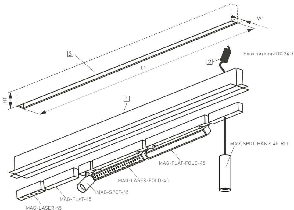
Рис. 2. Монтаж магнитного шинопровода серии 4560
