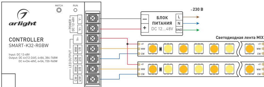
Рисунок 2. Схема подключения контроллера с лентами MIX
