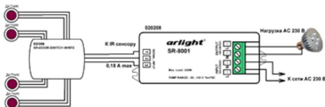
Система на 16 датчиков. Если открывается какая-либо дверь, включается свет.
