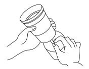
Подключите светодиодный модуль к разъему драйвера в корпусе светильника.
