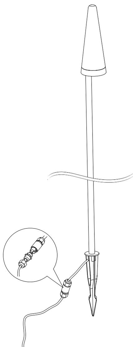
Рис. 2. Установка и подключение светильника
