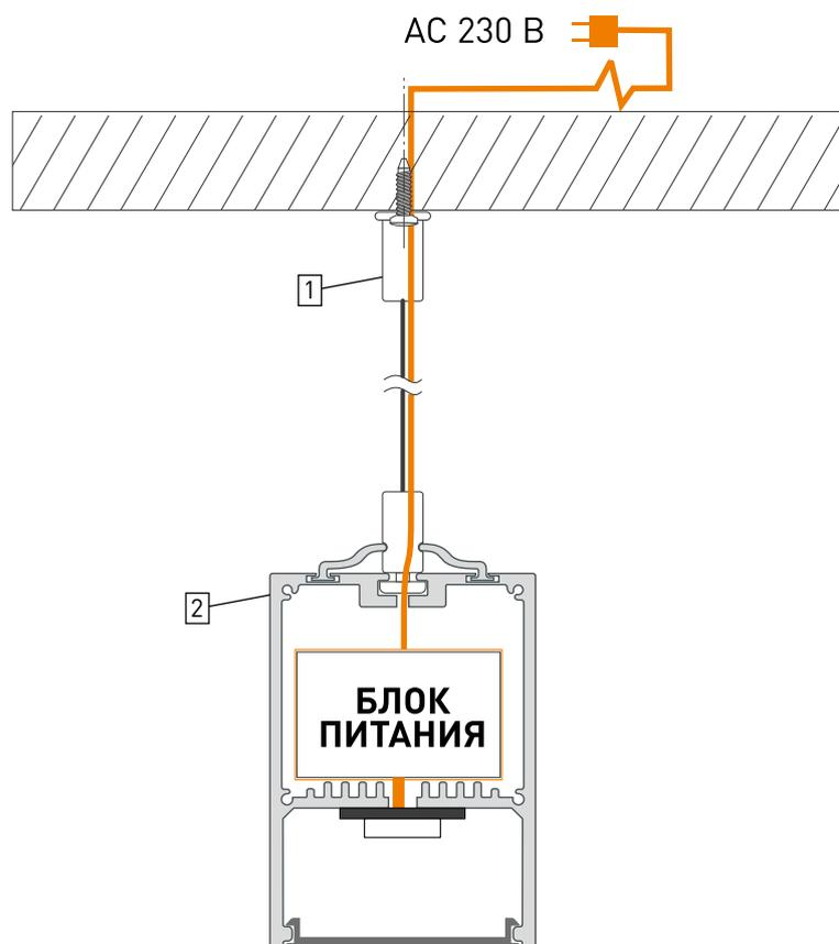
Рис. 1. Установка и подключение светильника
