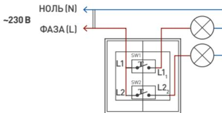
Рис. 2. Схема подключения
