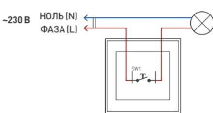
Рис. 1. Схема подключения
