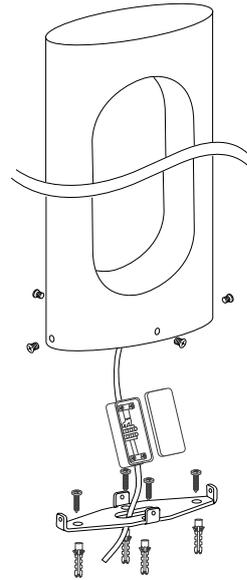
Рис. 2. Установка и подключение светильника
