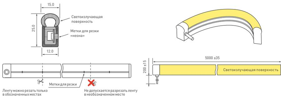
Вывод кабеля питания выполнен сбоку, перпендикулярно линии сечения «неона» с одной стороны. Длина кабеля питания —  $200 \pm 15$  мм.
