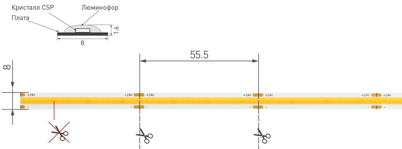
Ленту можно разрезать только в обозначенных местах по линии между контактными площадками для пайки.
