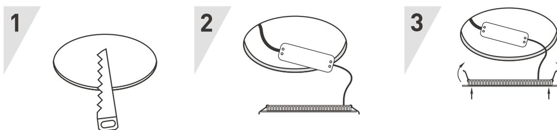
Рис. 2. Установка и подключение светильника
