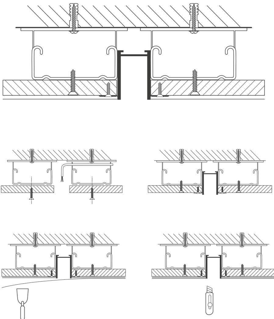
Рис. 3. Схема установки шинопровода
