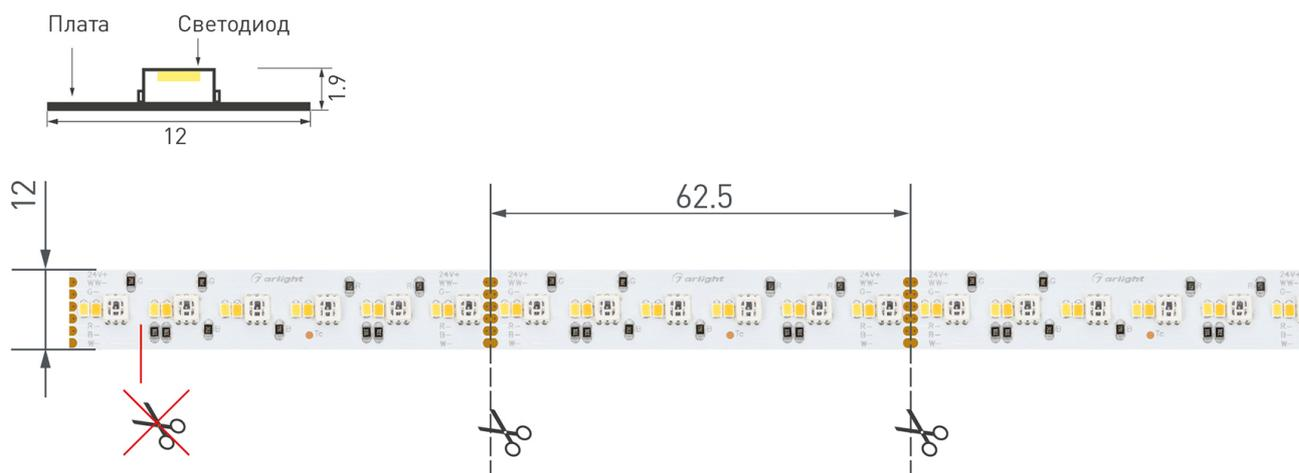
Не допускается разрезать ленту в необозначенном месте.
