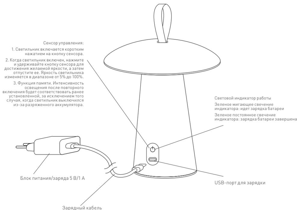
Рис. 2. Подключение светильника
