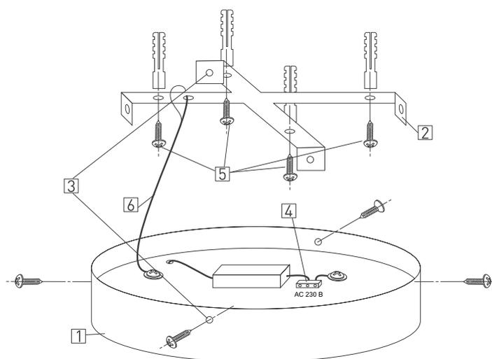
Рис. 2. Установка и подключение светильника
