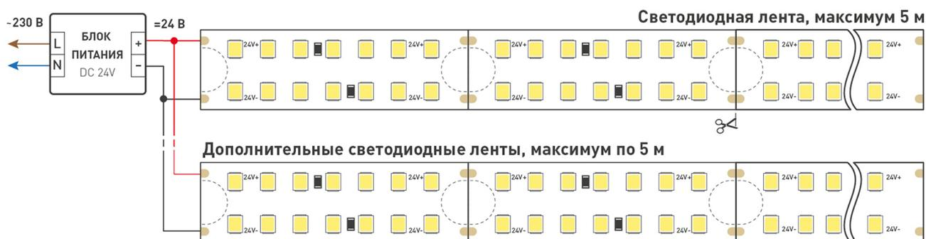
Схема подключения нескольких светодиодных лент с одной стороны.
