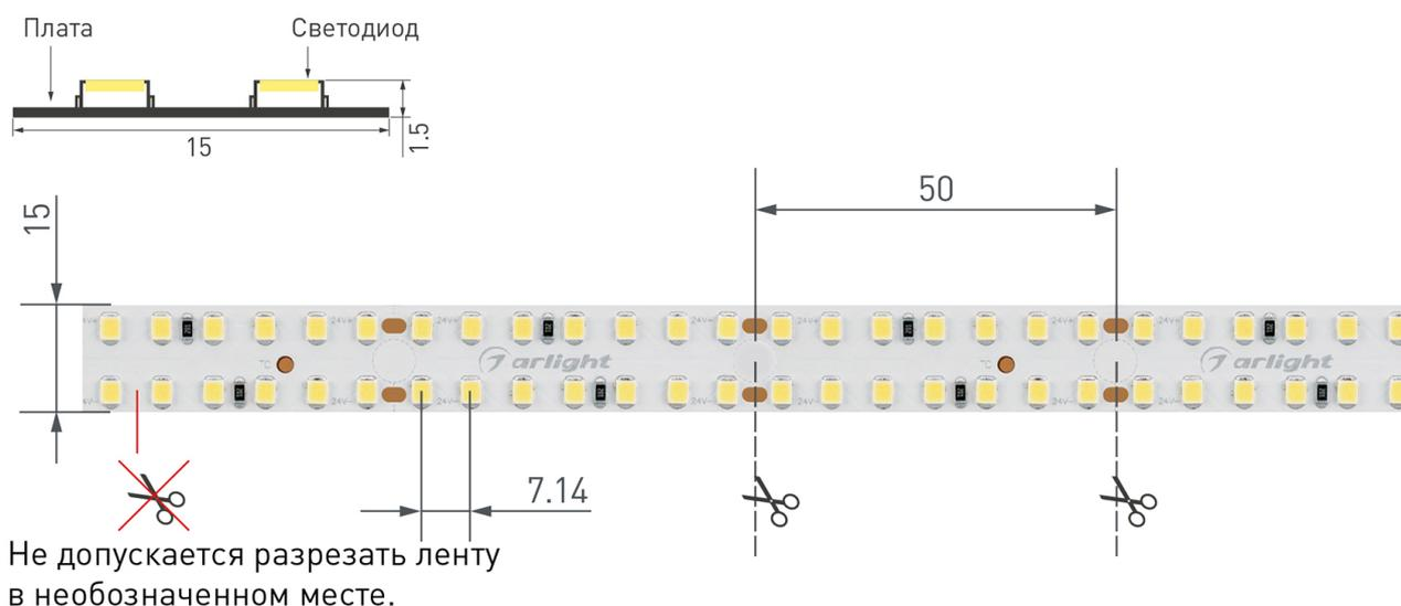
Ленту можно резать только в обозначенных местах по линии между контактными площадками для пайки.
