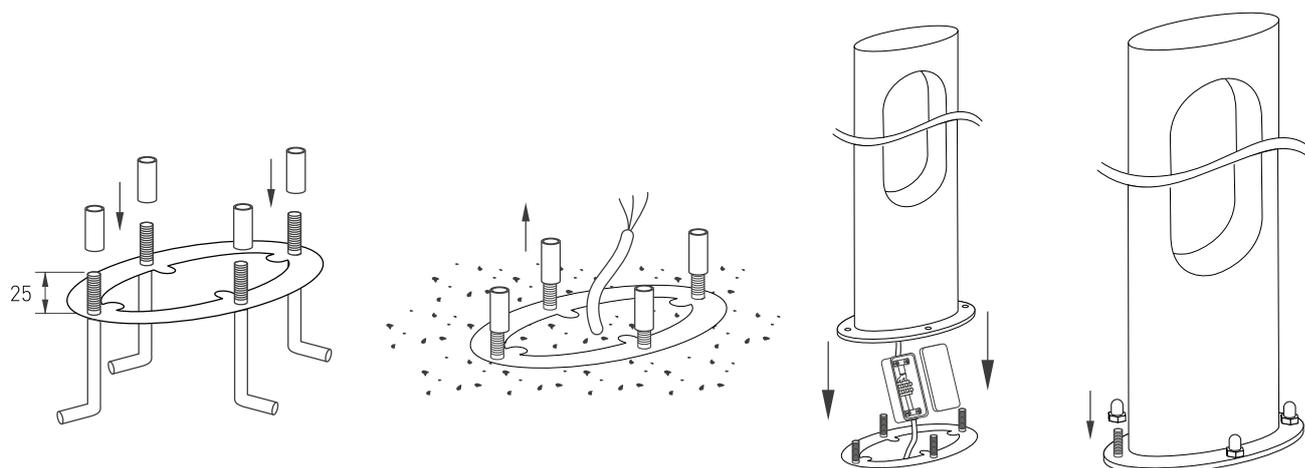
Рис. 3. Установка и подключение светильника
