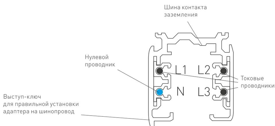
Рис. 1. Конструкция шинопровода
