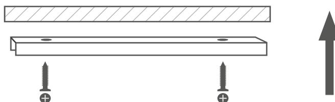
Рис. 2. Крепление шинопровода с помощью крепежных элементов
