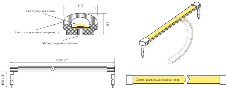
Вывод кабеля питания выполнен сбоку перпендикулярно линии сечения «неона» с обеих сторон ленты. Длина кабелей питания — 500 ± 15 мм. Цветовая маркировка проводов питания: красный провод — «+24 В»; черный провод — «-24 В».
