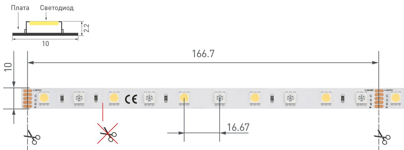
Не допускается разрезать ленту в необозначенном месте.
