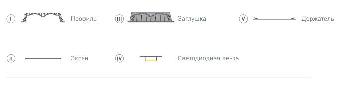
1 В гипсокартоне толщиной не менее 12.5 мм подготовьте проем шириной 130 мм для установки профиля (). Выведите наружу кабель от источника питания для светодиодной ленты. Просверлите отверстия в профиле () для вывода кабелей питания светодиодных лент и установите в них проходные изоляционные втулки.
