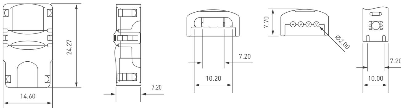
Размеры имеют допуск ±0.1 мм.
