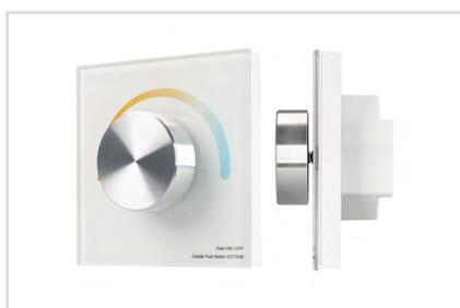
Встраиваемая роторная стеклянная панель 2,4 ГГц белого цвета. Для управления MIX (CCT) источниками света (ШИМ). Управление цветовой температурой с помощью роторного вращателя. Работает в режиме Master/Slave и может выполнять функцию независимого контроллера. Питание/рабочее напряжение DC 12–24 В, 2 пары параллельных каналов по 3 А максимальной нагрузки на канал, максимальная суммарная мощность 144–288 Вт. Габариты 86×86×50 мм. Панель совместима с контроллерами и пультами серии SMART.
