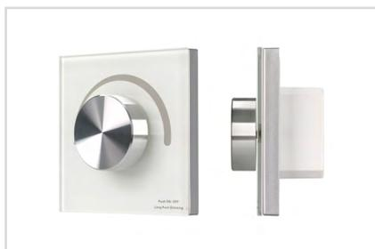
Встраиваемая роторная стеклянная панель 2,4 ГГц белого цвета. Для управления одноцветными источниками света (ШИМ). Управление яркостью с помощью роторного регулятора. Работает в режиме Master/Slave и может выполнять функцию независимого контроллера. Питание/рабочее напряжение DC 12–24 В, 4 параллельных канала по 3 А максимальной нагрузки на канал, максимальная суммарная мощность 144–288 Вт. Габариты 86×86×50 мм. Панель совместима с диммерами серии SMART.
